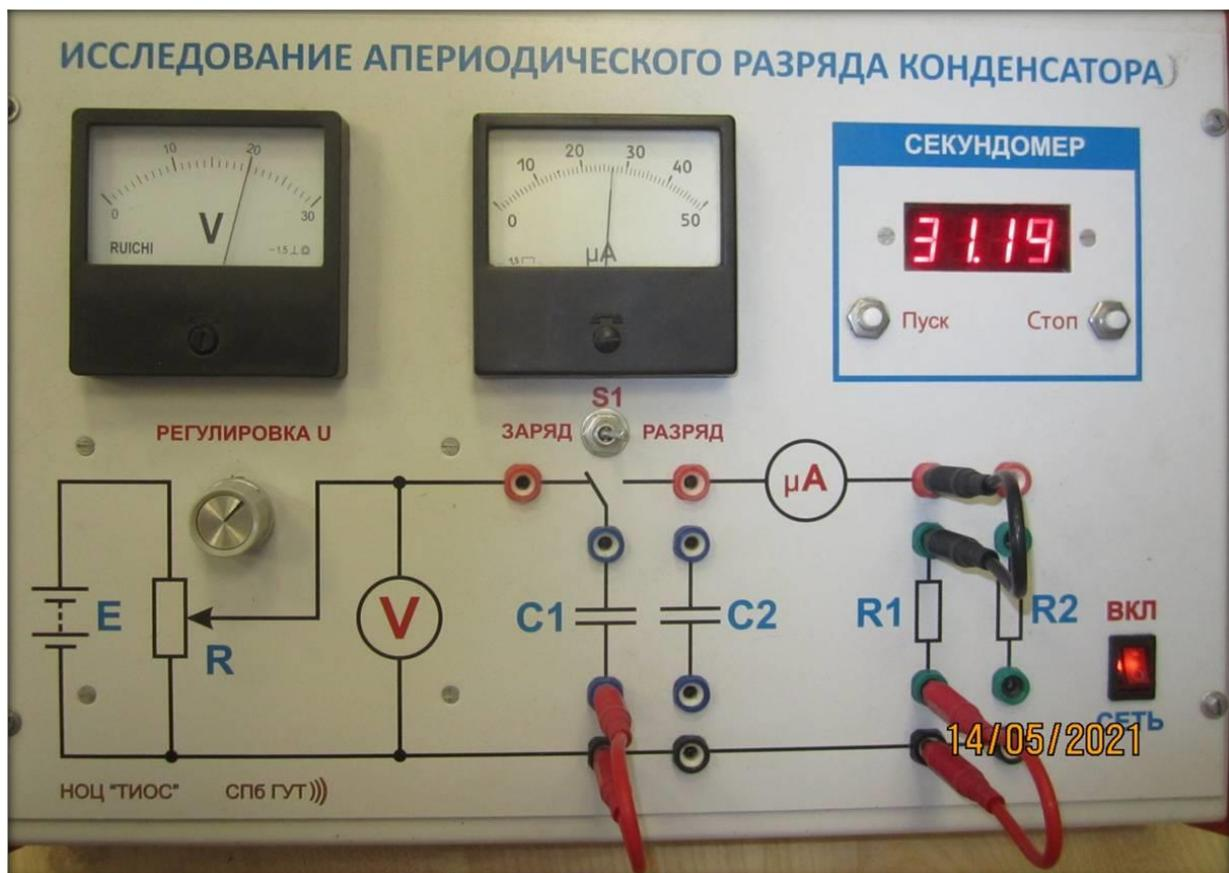
Рис. 6.1. Модуль лабораторной установки
