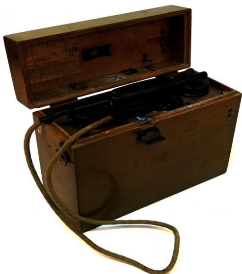
Рис. 1. Аппарат телефонный полевой с индукторным вызовом УНА-И. 1931. ВИМАИВuBC
