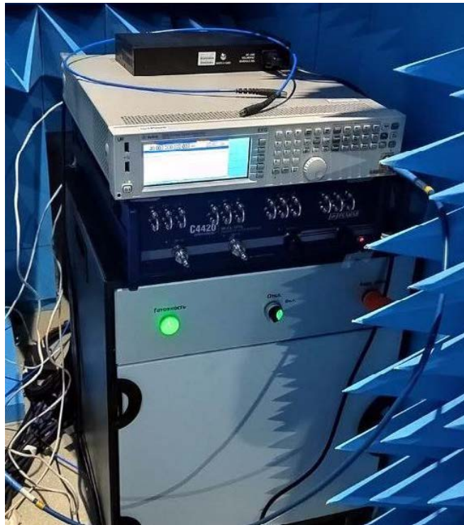
Рисунок 4.10 — Генератор для излучения радиосигналов в диапазоне 2300 - 2620 МГц
