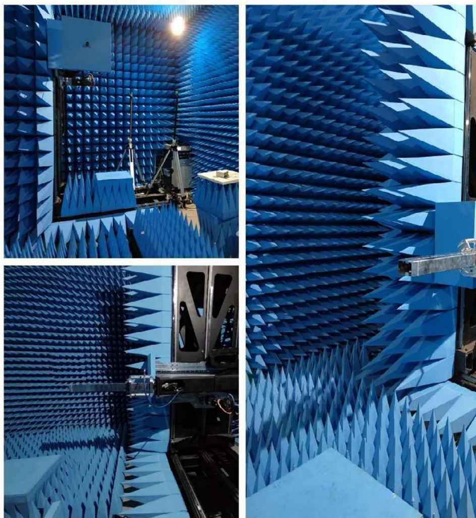
Рисунок 4.12 — Стенд ближнего поля с измерениями на плоскости
