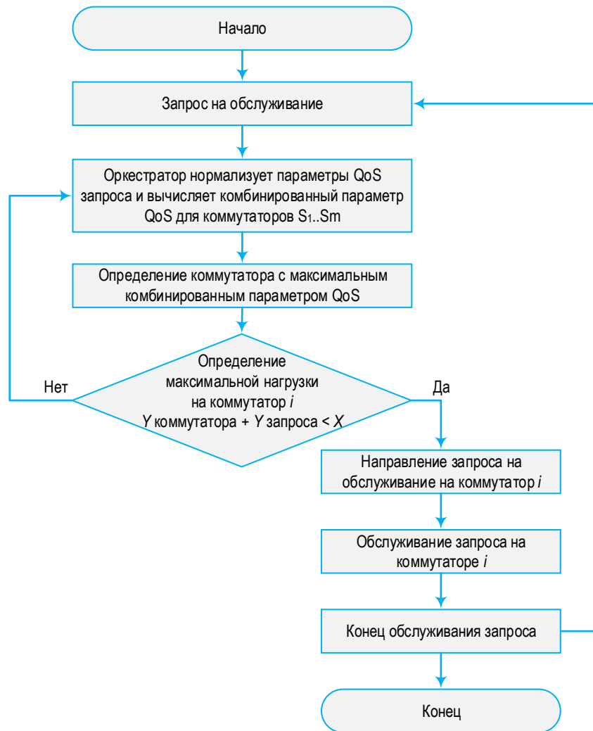
Рисунок 4 — Методика балансировки трафика коммутаторов по комбинированному параметру QoS
