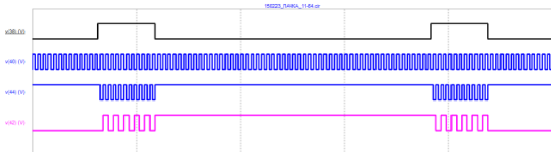
Рис.1.16,б. Формирование пачки импульсов для случая P = 128, Q = 11 , временные диаграммы
