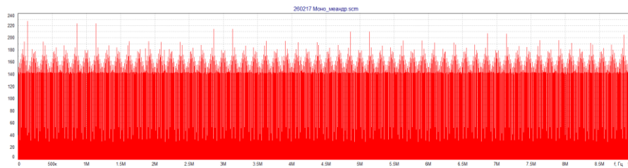
Рис. 3.23.г. Распределение спектральных компонент выходного сигнала многоуровневого ПЦС с моногармонической огибающей при P = 1000 , Q = 139 для модели с дополнительным тактированием: а) в программе Microcap12; б) в программе FASTMEAN 6.1
