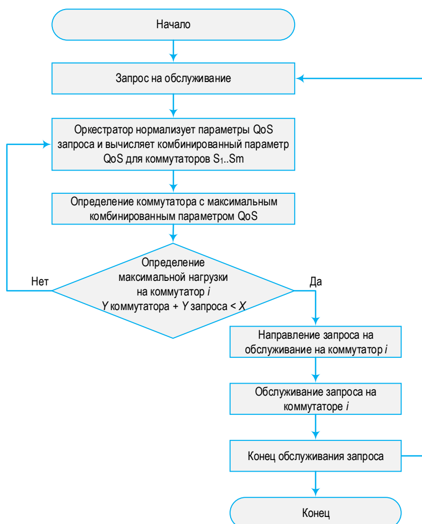
Рисунок 4.1 — Методика балансировки трафика коммутаторов по комбинированному параметру QoS
