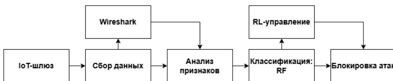
Рис. 1. Последовательность действий, выполняемая в ходе предложенного трехэтапного подхода
