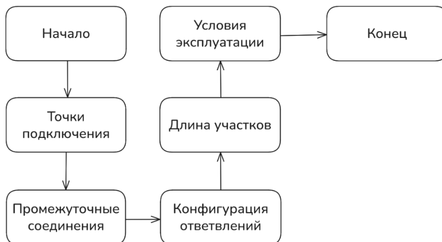
Рис. 1. Структурные параметры линии связи, учитываемые при формировании сигнального профиля
