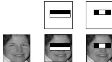
Рис. 4. Принцип работы примитивов Хаара
