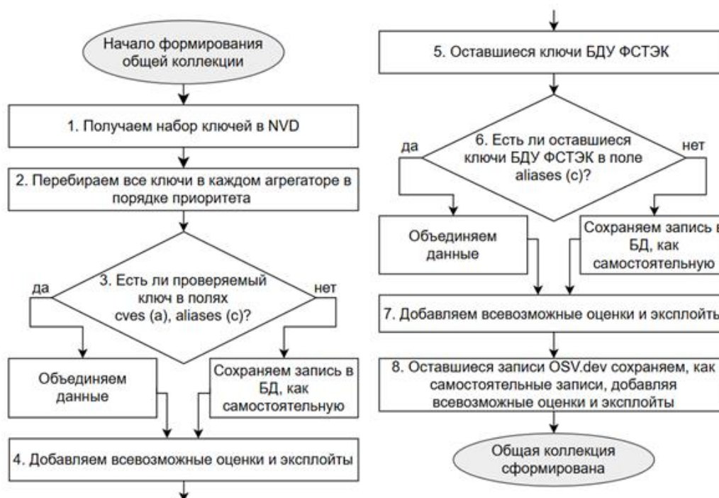
Рис. 2. Алгоритм объединения, согласования и обогащения данных об уязвимостях
