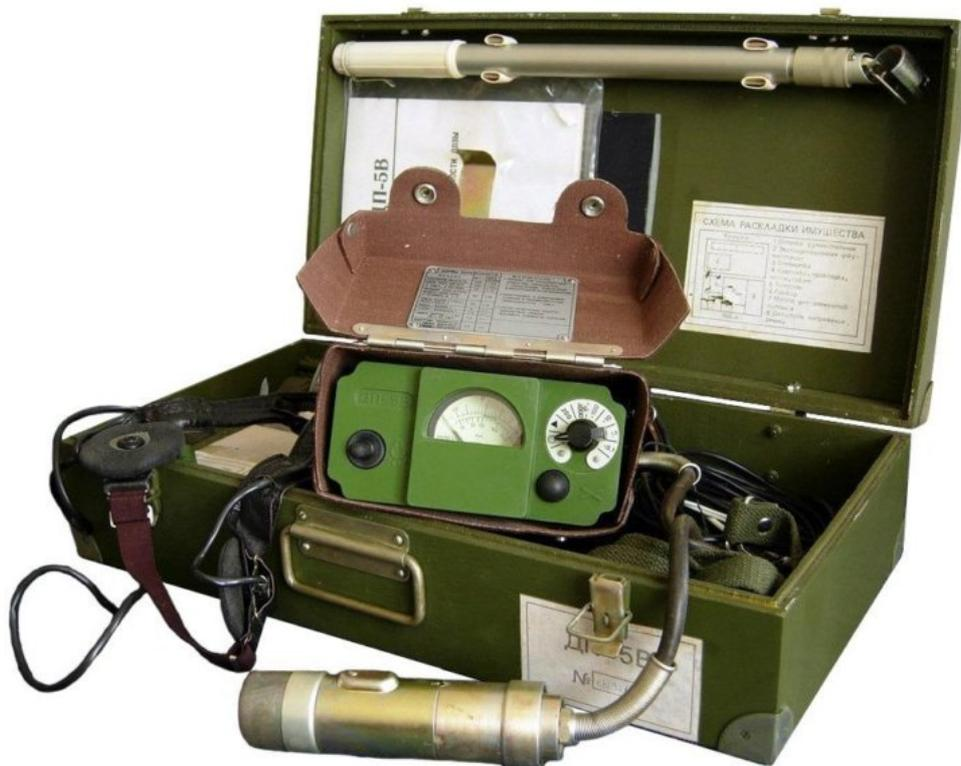
Рис. 1 Измеритель мощности дозы (рентгенметр), ДП-5В
