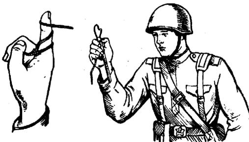
Рис. 8. Наматывание шнура и отсчет по термометру
