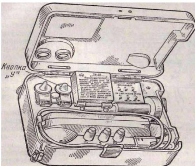
Порядок подключения ТА-57 к линейным проводам показан на панели аппарата. Перед включением аппарата концы кабеля заделывают на 3 см,
