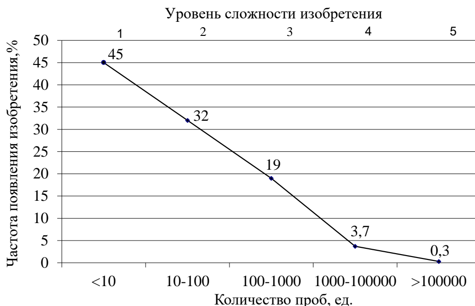
Рис. 3.1. Частота появления изобретения в зависимости от уровня сложности, определяемого количеством проб
