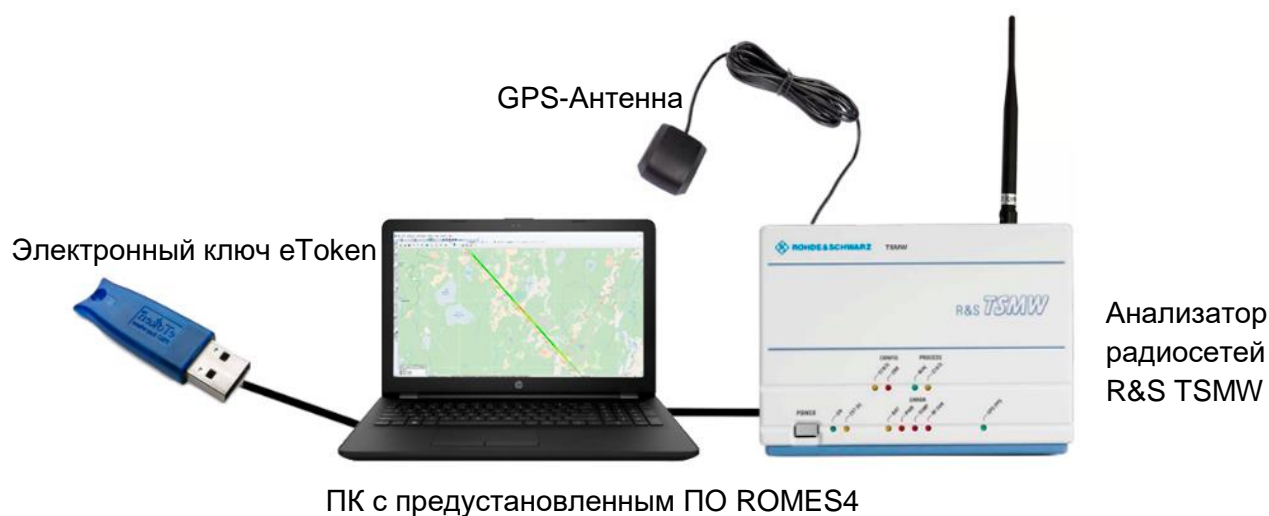
Рисунок 11: Схема подключения оборудования для измерений карты покрытия системы TETRA
