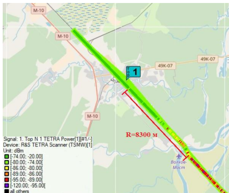
Рисунок 12: Результат измерений в районе базовой станции BS2545
