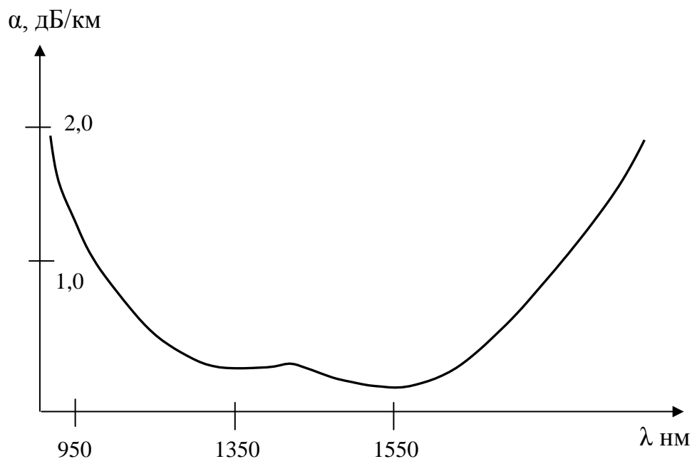
Рис. 5.8. Спектральная зависимость затухания для волокна LWPF
