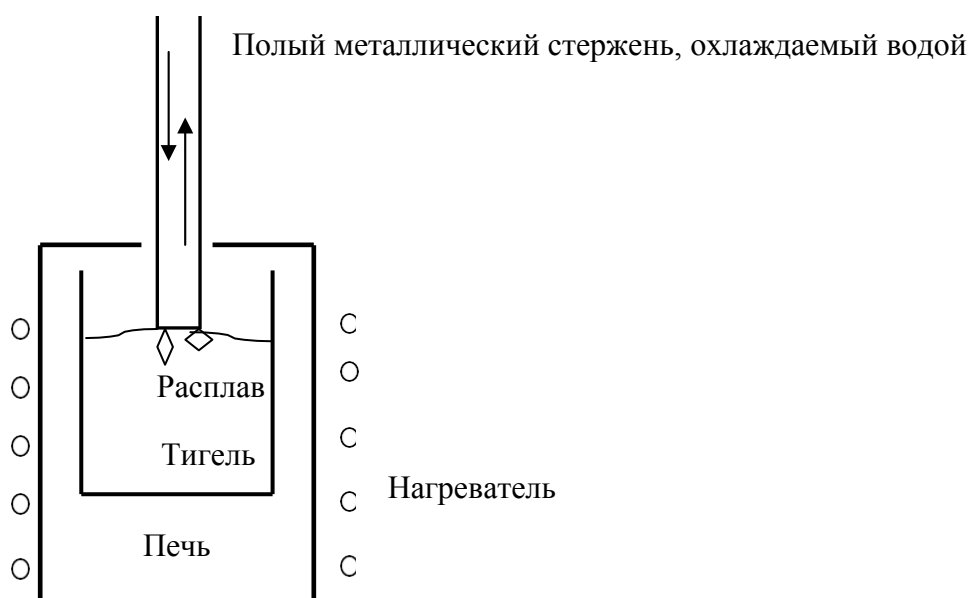
Рис. 3.6, а. Кристаллизация из расплава методом Наккена. Рост и ориентация кристалла не контролируются
