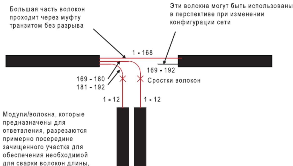
Рис. 6.16. Доступ к сердечнику ВОК с сохранением целостности транзитных ОВ.
