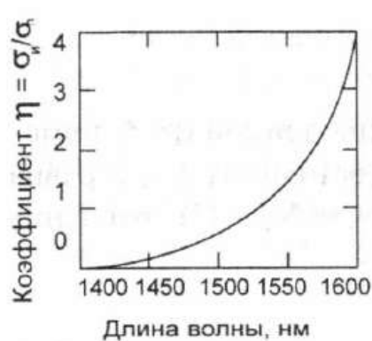
Рис. 5.11. Зависимость отношения сечения испускания к сечению поглощения от длины волны
