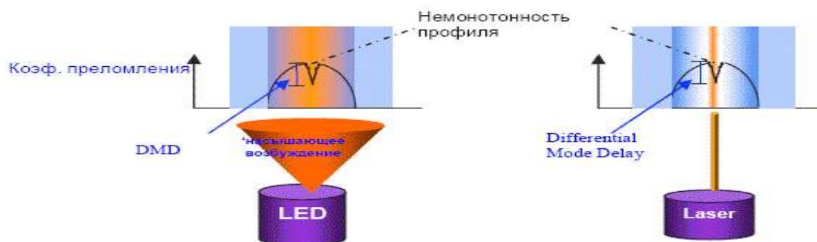
Рис. 1.4. Использование светоизлучающего диода и лазера для ввода излучения в многомодовое ОВ.
