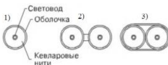
Рис.4.5. Конструкции оптических кабелей для шнуров
