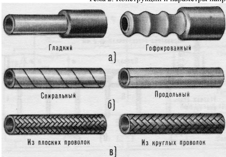
Рис. 2.7. Металлические оболочки – экраны кабелей связи:
