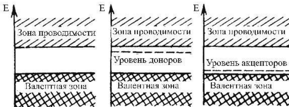
Рис. 22. Зонная структура полупроводников.
