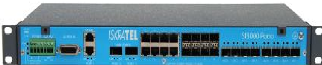
Рис. 4.2. Внешний вид коммутатора OLT в конструктиве 1U ( коммутатор GPON OLT SI3000PoBa производства компании ISKRATEL, Словения ).
