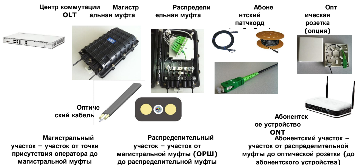
Рис. 2.2. Структура сети PON со всеми базовыми элементами.
