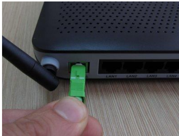
Рис. 3.2. Подключение патч-корда SC/APC.
