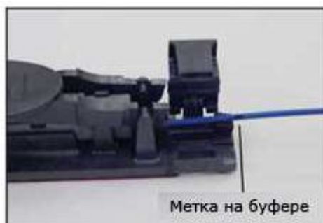
Рис. 2.12. Нанесение метки на буфере.
