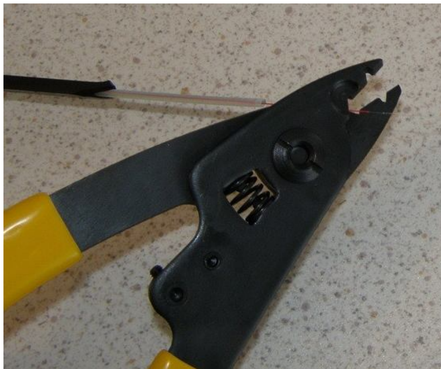
Рис. 2.4. Пример специального кабельного стриппера для снятия изоляции с оптического волокна.
