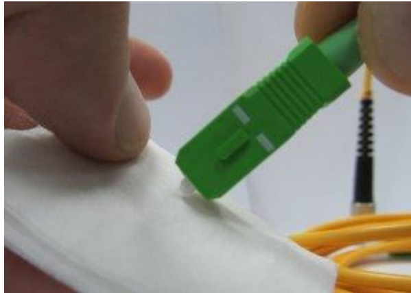
Рис. 3.1. Очистка торцов коннектора.
