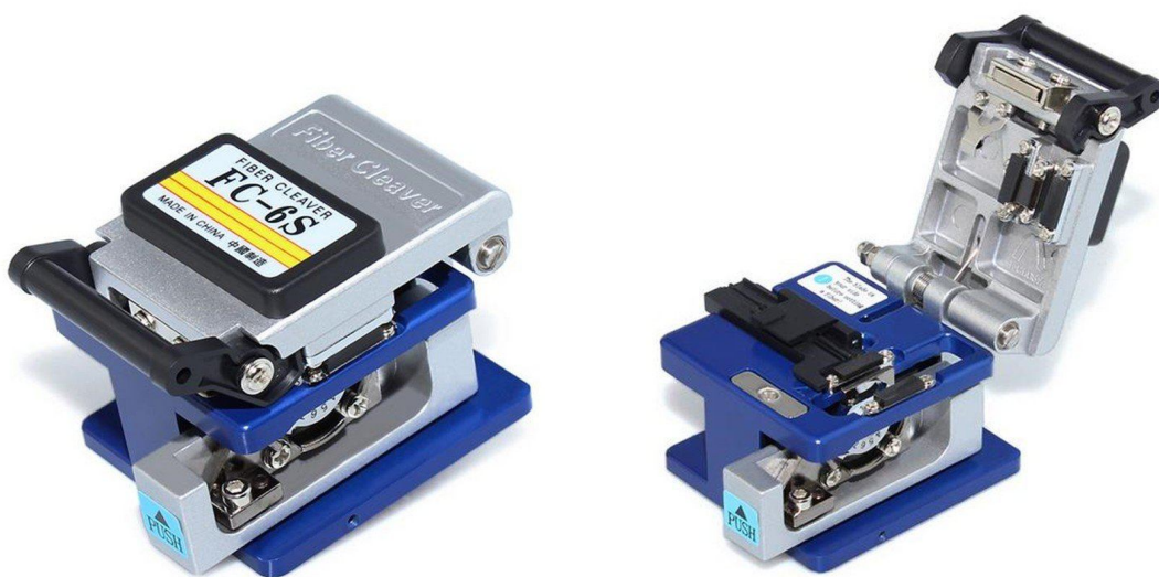
Рис. 2.5. Внешний вид прецизионного механического скальвателя Sumitomo FC-6S-C.
