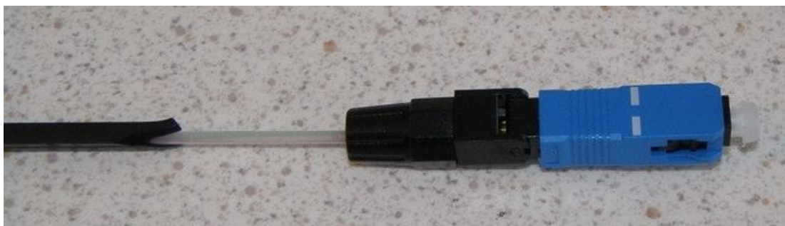
Рис. 2.9. Итоговый результат при работе с «быстрым коннектором».
