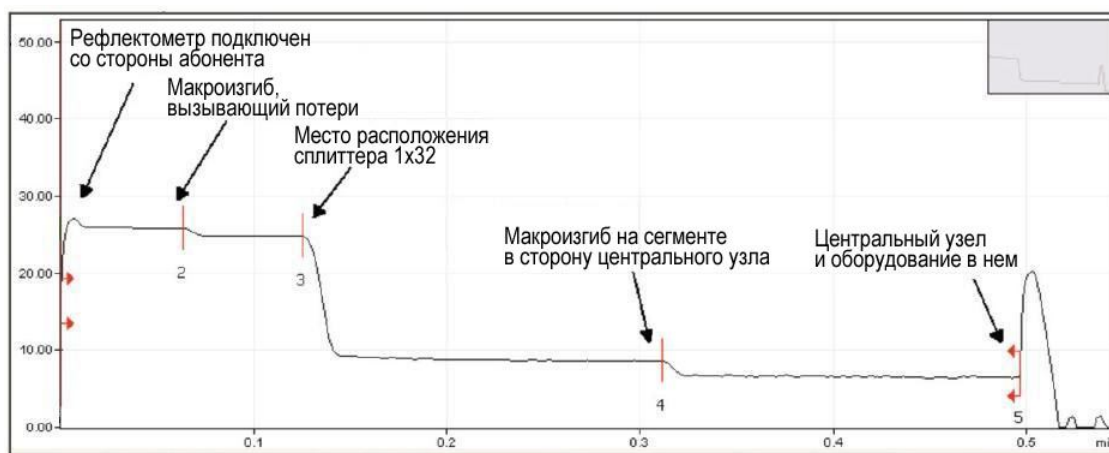
Рис. 5.4. Пример рефлектограммы, снятой со стороны абонента (ONT).
