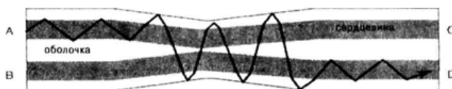
Рис. 7.5. Разветвитель на основе многомодового волокна
