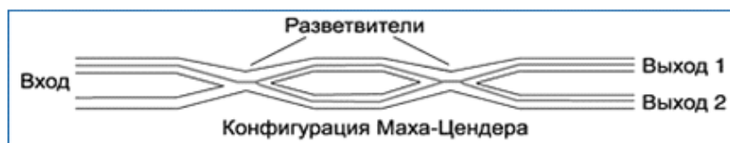
Рис. 7.8. Распределение входного сигнала между 2 выходами
