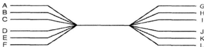
Рис. 7.2. Звездообразный разветвитель передающего типа
