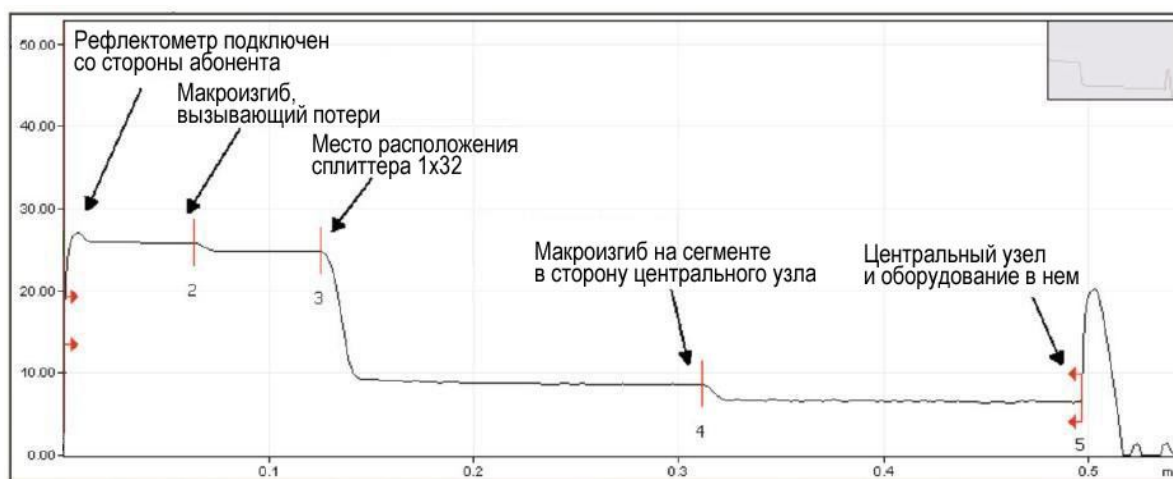
Рис. 9.9. Пример рефлектограммы, снятой со стороны абонента (ONU/ONT)
