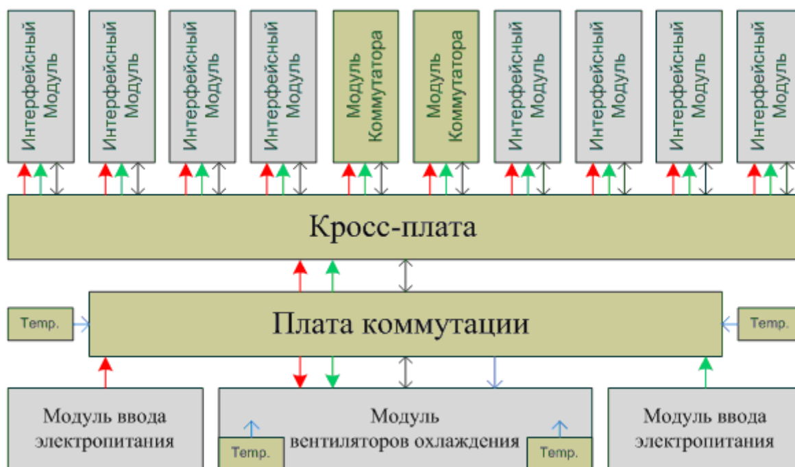
Рис. 6.2. Структурная схема разрабатываемого блока коммутатора OLT PON
