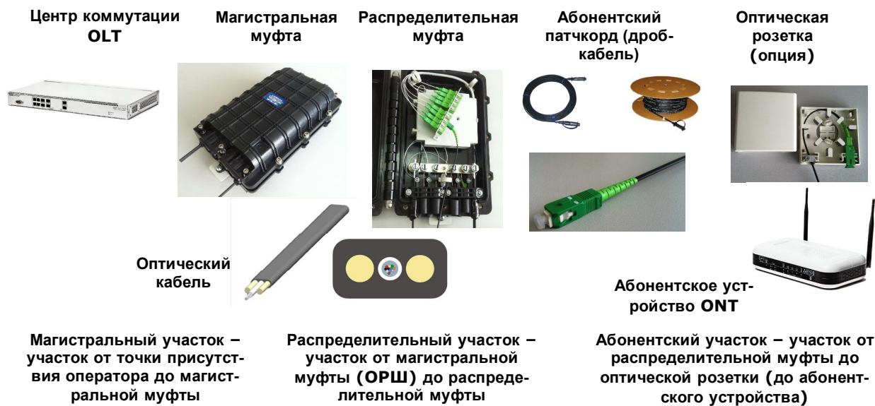
Рис. 10.3. Структура сети PON в малоэтажном жилом секторе
