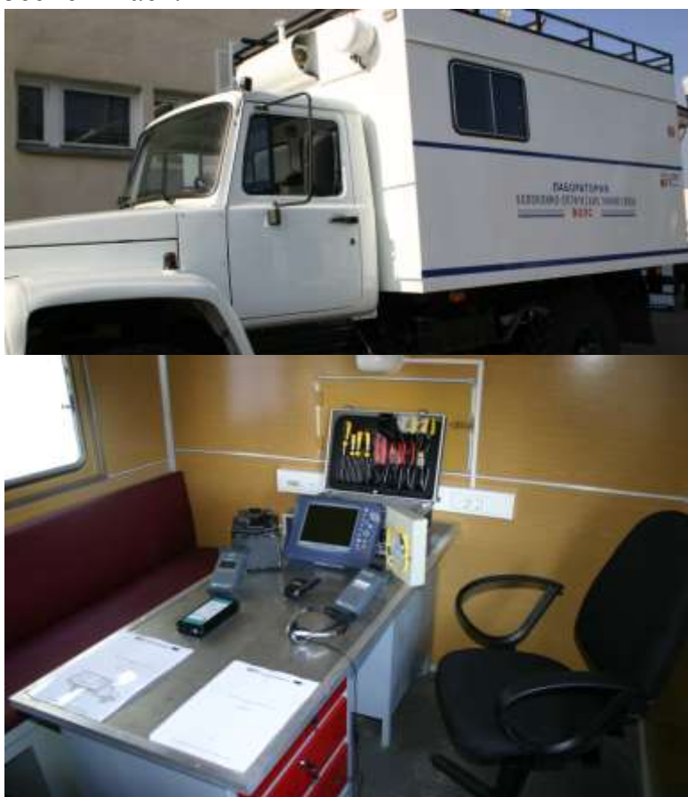
Передвижная лаборатория по монтажу, ремонту и восстановлению волоконно-оптического кабеля.
