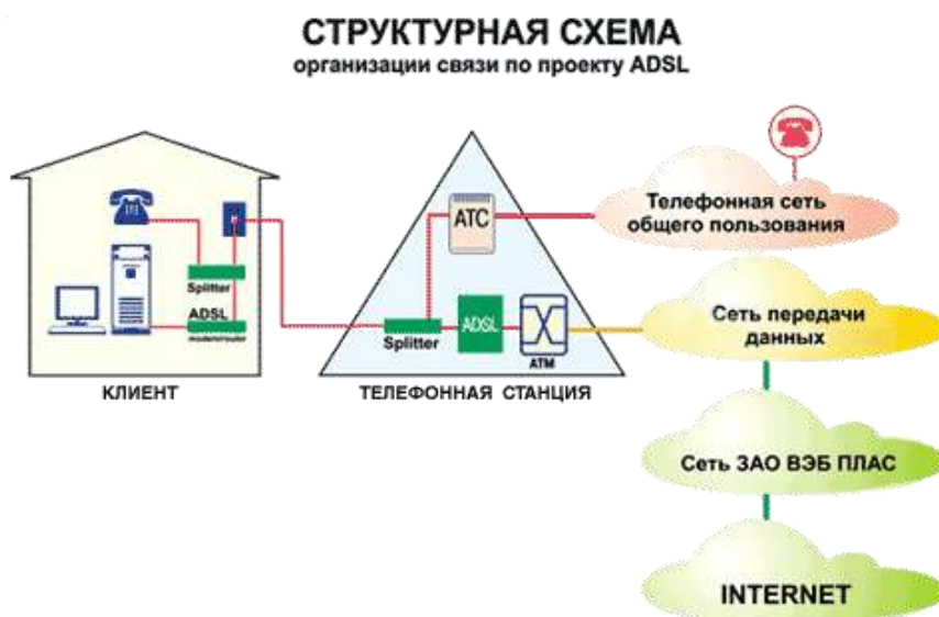
Рис. 4.2. Схема подключения по технологии ADSL.
