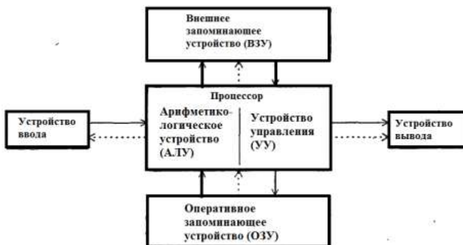
Рис. 2.1. Архитектура ЭВМ фон Неймана
