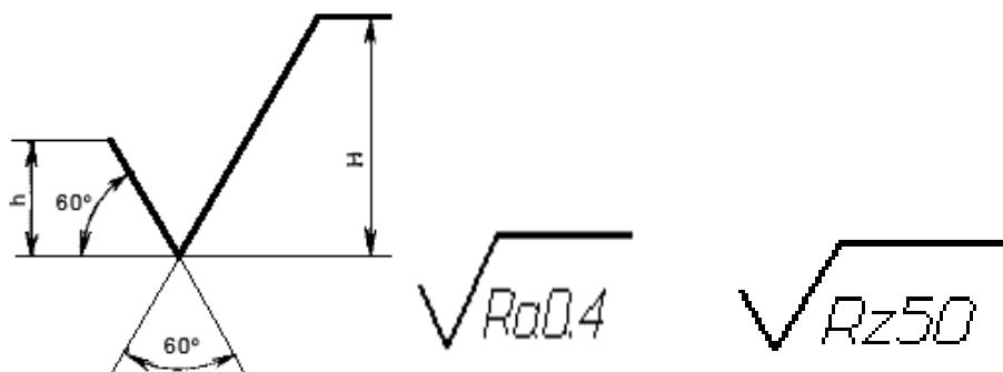
Рисунок 2. Обозначение шероховатости поверхности без указания способа обработки
