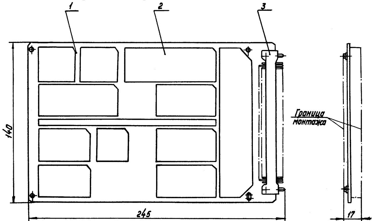
Рис.2. Гибкий печатный кабель с двухрядными контактными лепестками.
