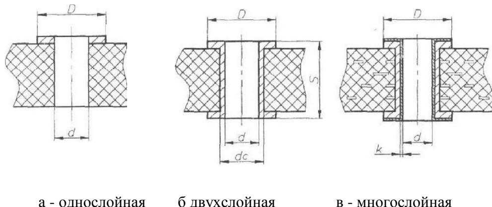
Рис. 2.6— Варианты конструкций отверстий ПП
