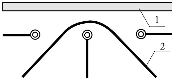
Рис.2.6. Излом печатного проводника, находящегося под высоким потенциалом:
