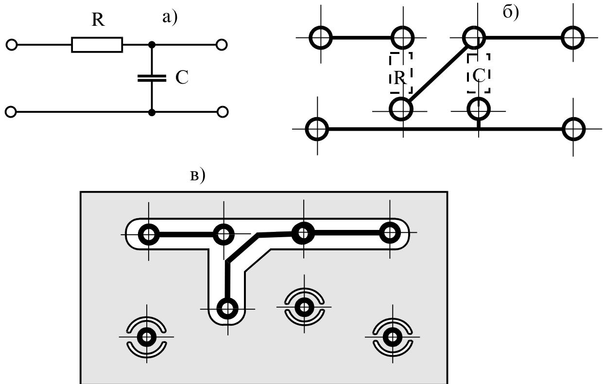
Рис. 2.2. Фрагмент печатной платы с развязывающим фильтром:
