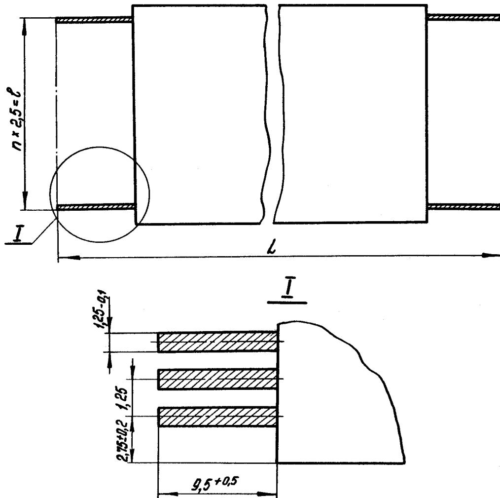
Рис. 4. Гибкий печатный кабель с однорядными контактными лепестками одинаковой длины: L - длина кабеля (не более 348 мм); 1 - ширина кабеля (не более 57,5 мм)
