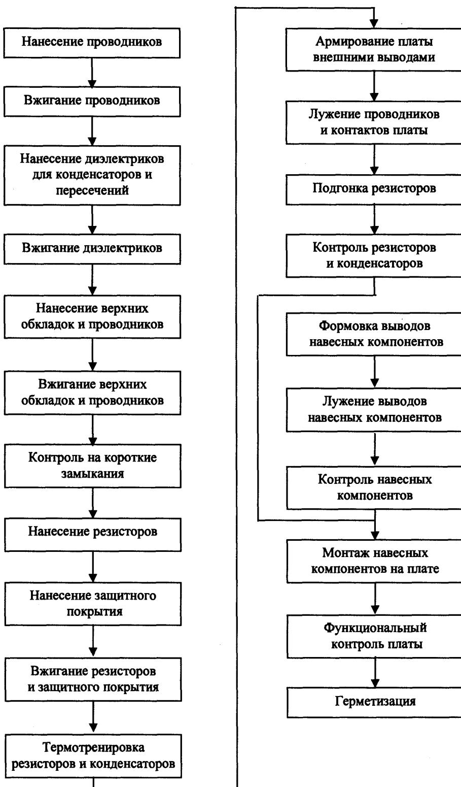
Рис.61. Основные этапы изготовления толстопленочных гибридных ИМС.
