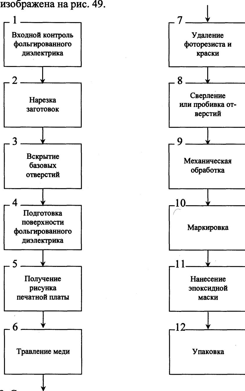
Рис. 49. Схема типового технологического процесса изготовления печатной платы химическим методом
