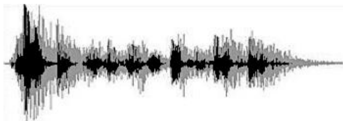
Рис. 10. Осциллограмма одного и того же отрывка речевого сигнала в заглушенной камере (темная часть осциллограммы) и в помещении (более светлая часть осциллограммы)
