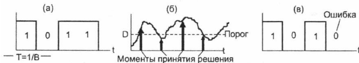
Рис. 5.1. Схема появления ошибки при восстановлении бинарного сигнала с модуляцией по интенсивности с NRZ кодированием; (а) сигнал на входе в линию, (б) сигнал на входе в регенератор, (в) сигнал на выходе регенератора.
