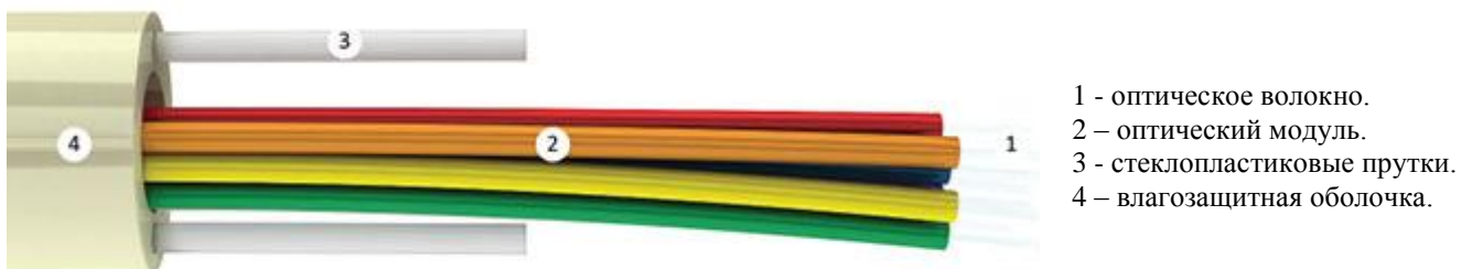
Рис. 3.53. ВОК с периферийными армирующими элементами.
