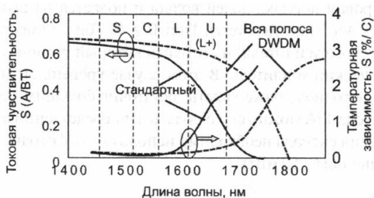
Рис. 3.10. Спектр токовой чувствительности быстродействующих p-i-n диодов на основе InGaAs
