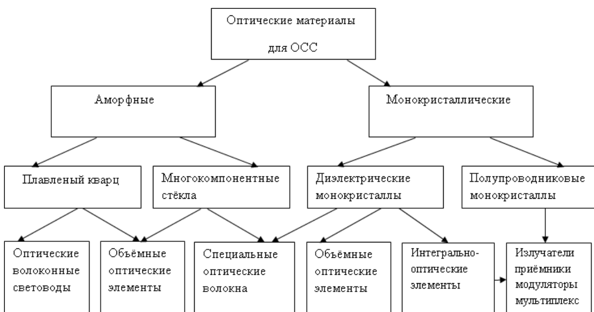
Рис.2. Материалы компонентов оптических систем связи
