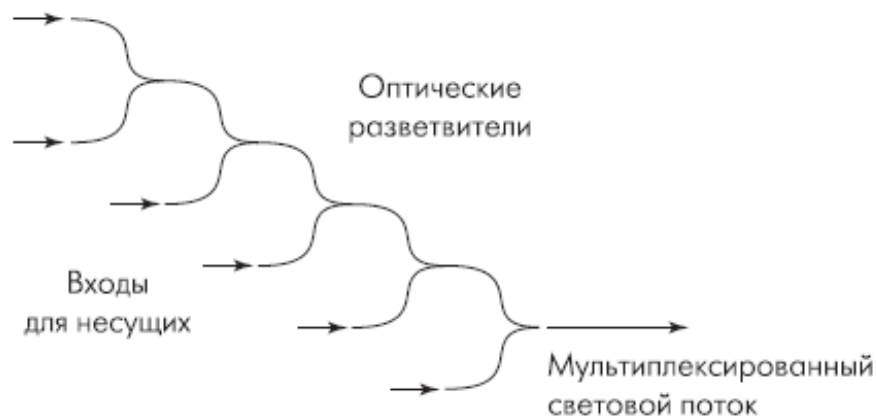
Рис.1.1. Схема мультиплексирования WDM на ОВНР.
