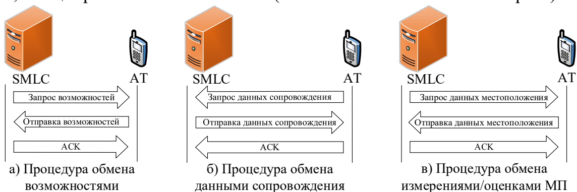
Рис. 1.33. Процедуры протокола LPP
