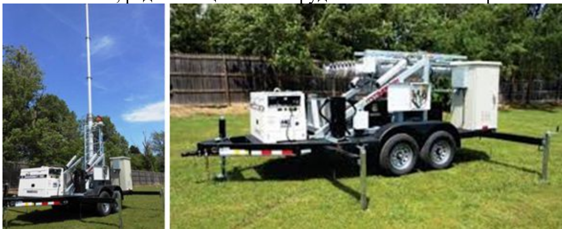
Рис. 4.1. Радиостанция наземного пункта центра НАСА Glenn Research Center [241]
