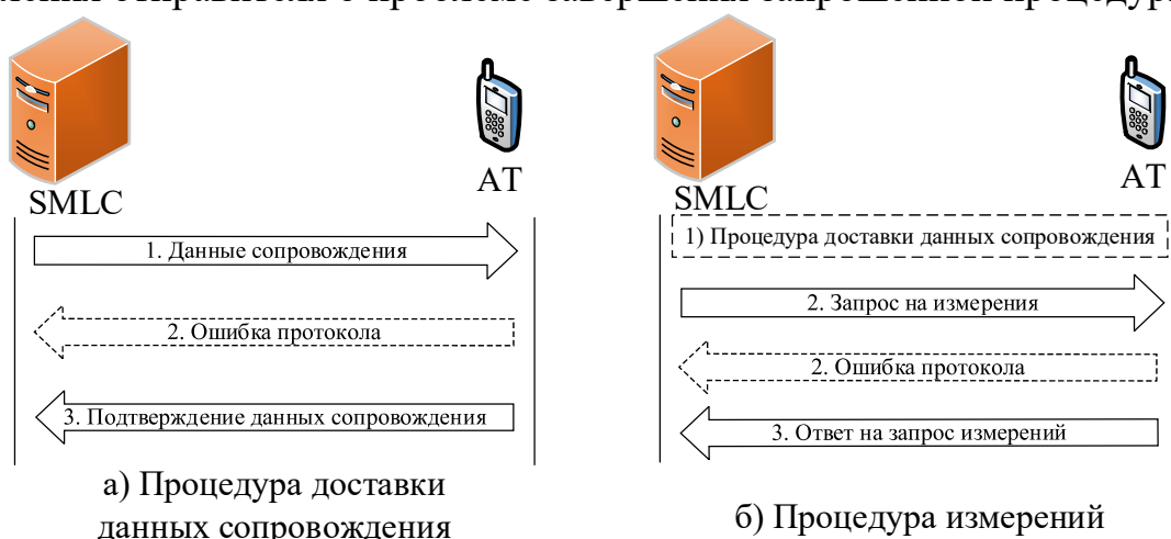
Рис. 1.27. Процедуры протокола RRLP: а) доставки данных сопровождения; б) измерения местоположения
