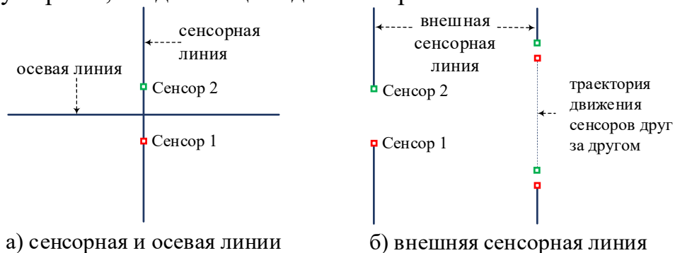
Рис. 2.43. Понятие сенсорной, осевой и внешней сенсорной линий
