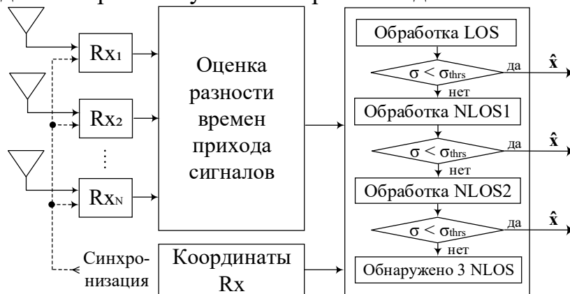
Рис. 3.12. Функциональная схема обработки РДМ измерений в условиях NLOS
