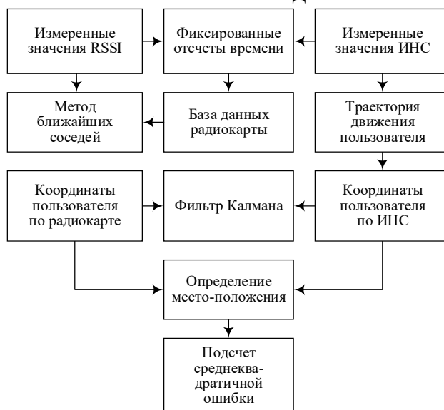
Рис. 6.2. Функциональная схема позиционирования по ИНС и RSSI
