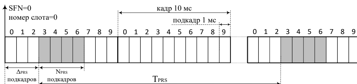
Рис. 1.7. Порядок передачи и конфигурация подкадров PRS
