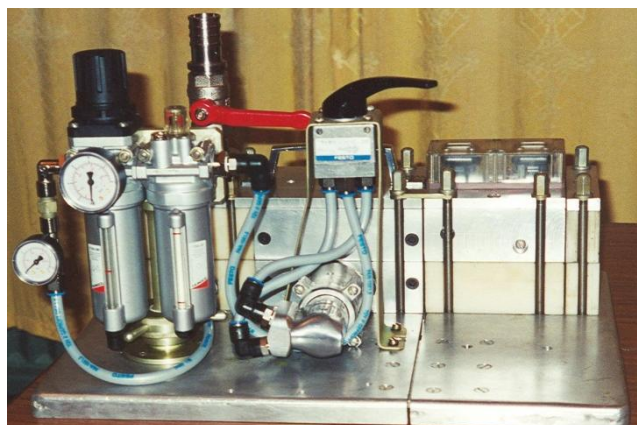
Рис. 5.5. Инжектор ПСИ-1 для задувки кабеля
