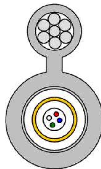
Рис. 1.5. Поддерживающий силовой элемент («восьмерка»)
