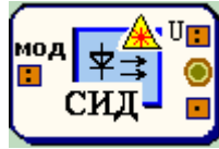
Источник излучения: светоизлучающий диод (СИД)
