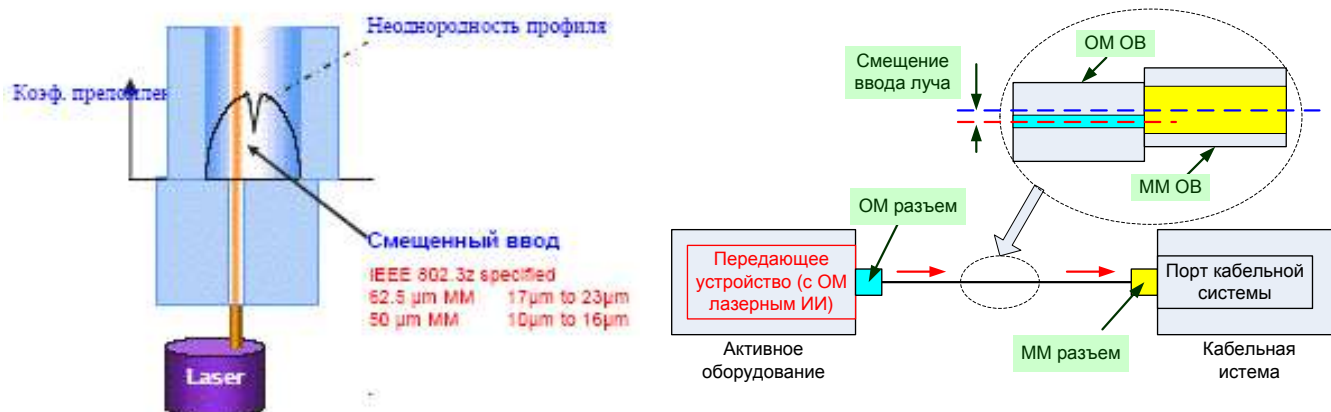
Рис. 5.15. Принцип и схема смещенного ввода светового луча в ММ ОВ
