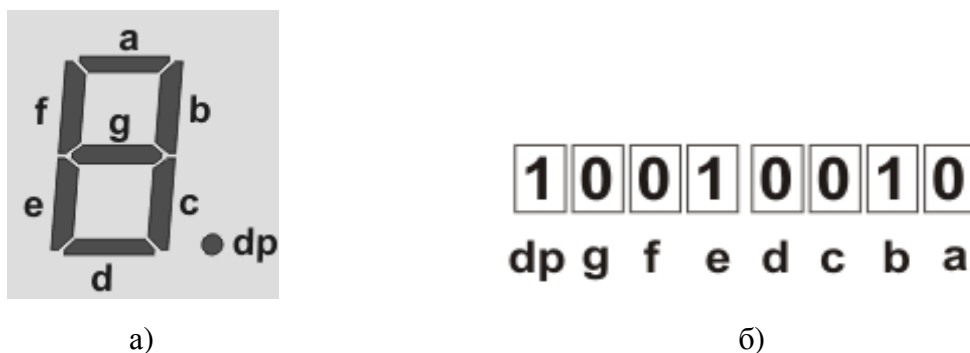
Рис. 1. Обозначения сегментов индикатора – а и их положение в разрядах кода – б
