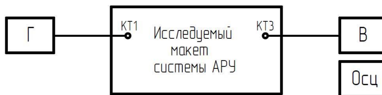
Рис. 5.2. Подключение измерительной аппаратуры к макету системы АРУ
