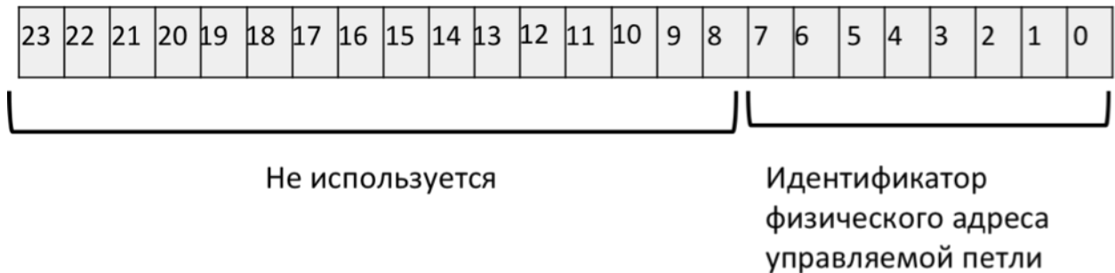
Рис. 37. 24-разрядный FC-адрес порта типа NL_port в частной петле
