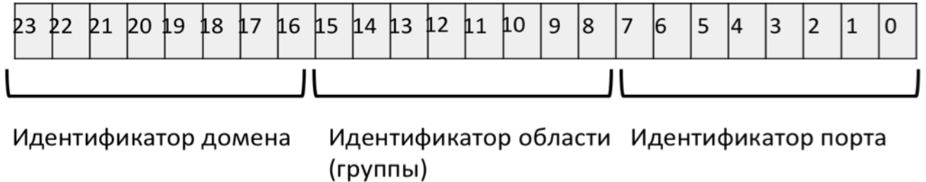
Рис. 36. 24-разрядный FC-адрес порта типа N_port
