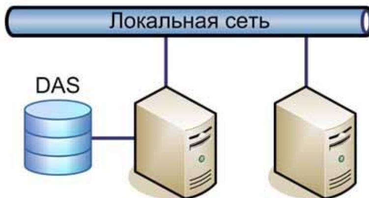
Рис. 2. Архитектура СХД Direct Attached Storage
