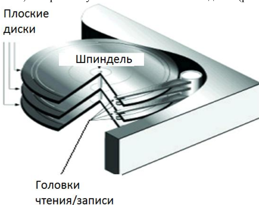
Рис. 3.1. Общая структура жесткого диска
