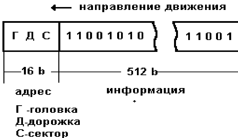
Рис. 3.5. Общая структура сектора на магнитном диске
