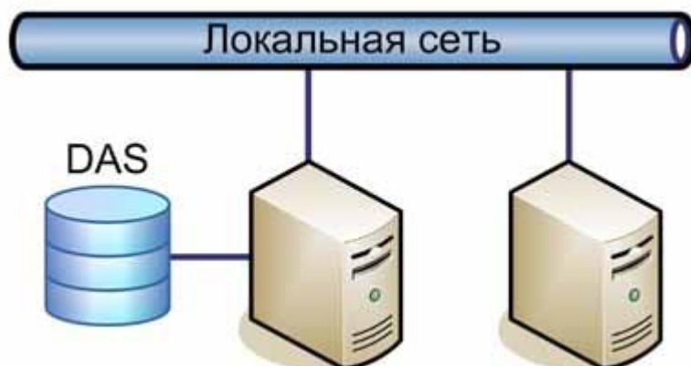
Рис. 2. Архитектура СХД Direct Attached Storage
