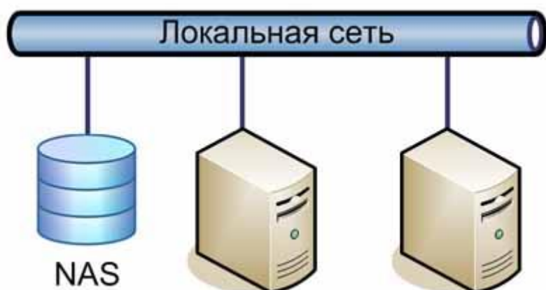
Рис. 3. Архитектура СХД Network Attached Storage
