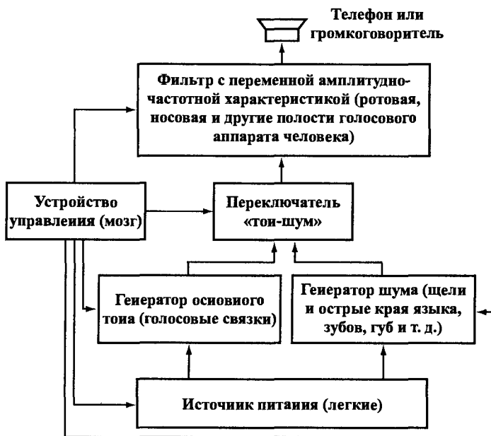
Рис. 11.5. Электрическая модель голосового аппарата человека
