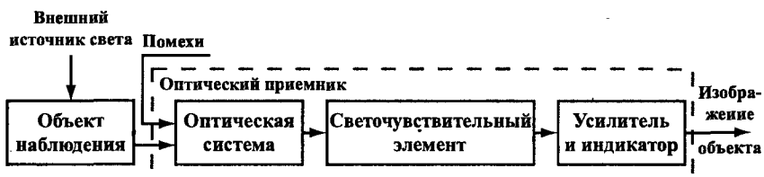
Рис. 16.1. Структурная схема оптического приемника
