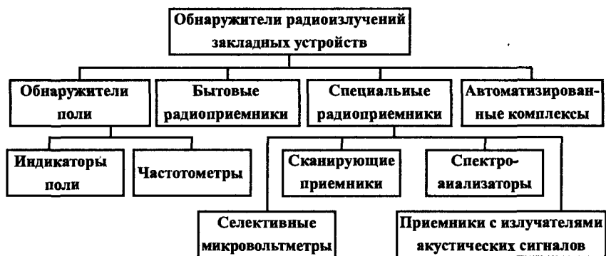
Рис. 23.3. Классификация средств обнаружения излучений закладных устройств
