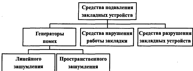
Рис. 23.5. Классификация средств подавления закладных устройств
