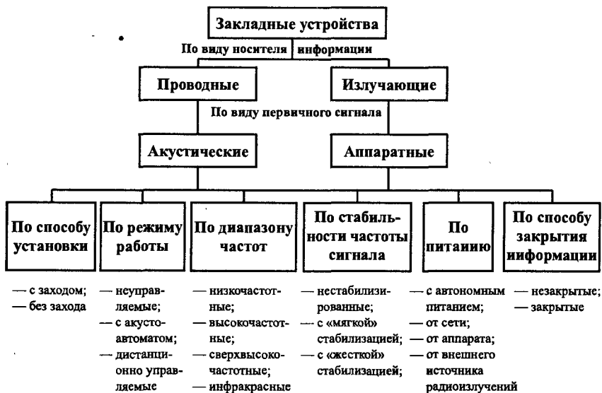
Рис. 15.7. Классификации закладных устройств
