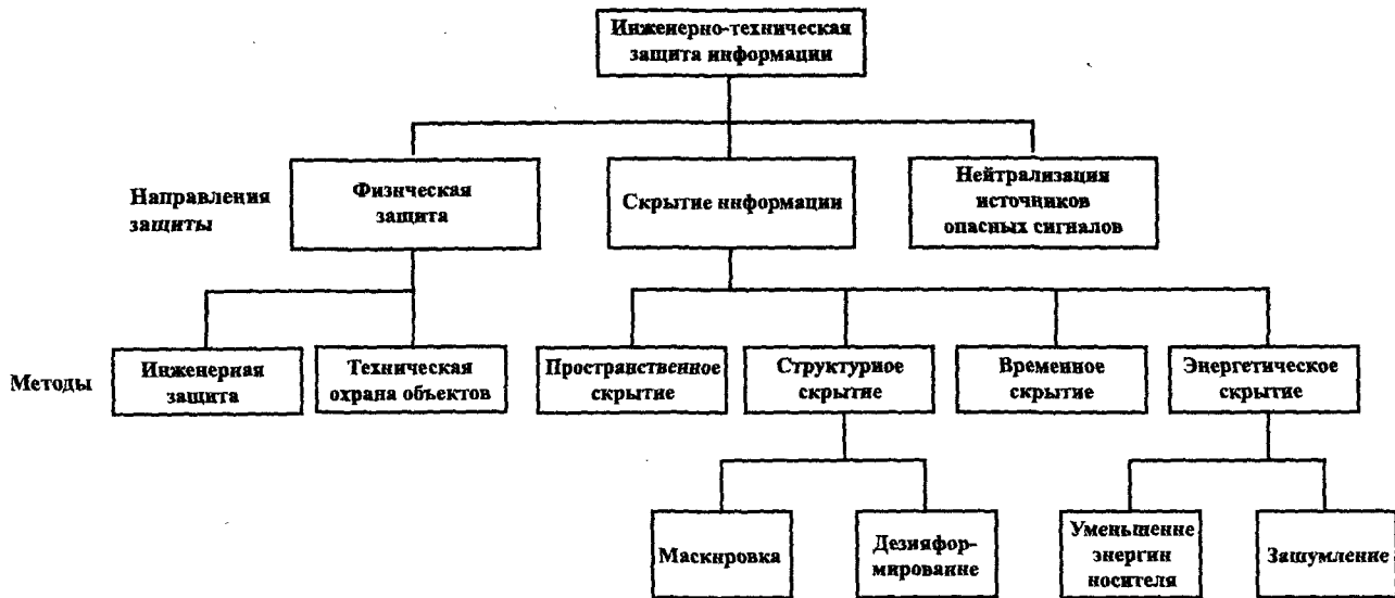
Рис. 8.4. Классификация направлений и методов инженерно-технической защиты информации
