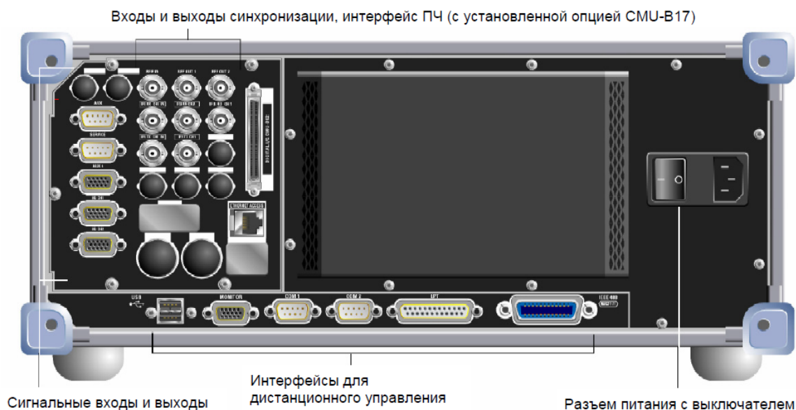
Рисунок П2.3 – Задняя панель радиотестера CMU
