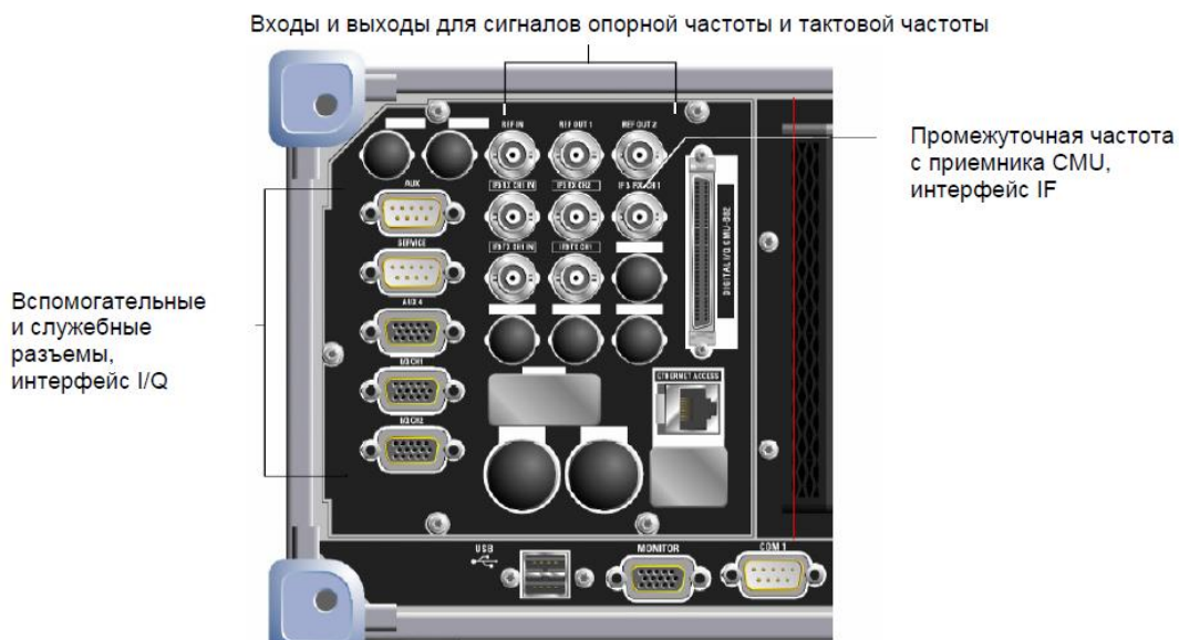
Рисунок П2.4 – Задняя панель радиотестера CMU: LAN и I/Q-IF входы и выходы
