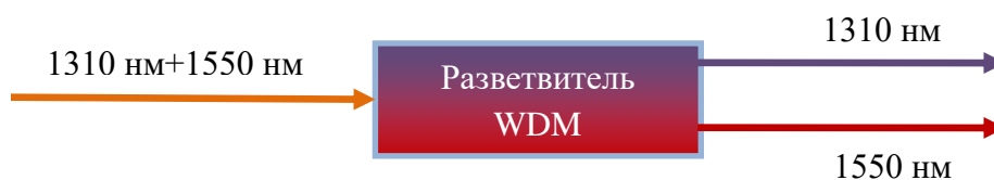
Рис.12. Схема WDM-сплиттера. Работа при разделении каналов.
