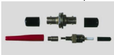
*Соединитель ST* был разработан в Bell Labs. Коннектор снабжен подпружиненной втулкой типа байонет, повернув которую на четверть оборота можно просто и надежно зафиксировать соединение. Средние потери на соединении 0,2 дБ. Соединитель прост и надежен в использовании. Однако, керамический наконечник жестко связан с корпусом разъема, что делает его чувствительным к вибрации. Применение его в системах видеонаблюдения производственного объекта требует учета его виброчувствительности.
