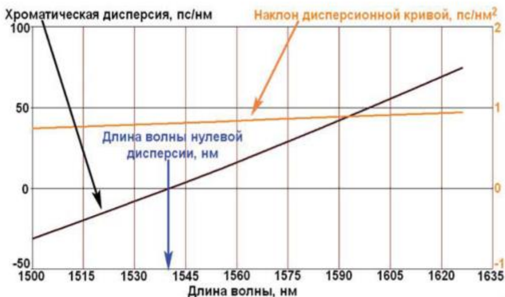
Рис.3.1. Зависимость хроматической дисперсии от длины волны D(\lambda) для световода со смещенной дисперсией.
