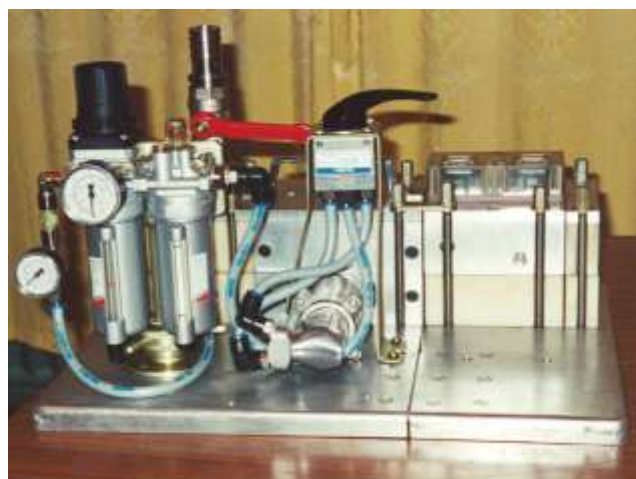
Рис.9.5. Инжектор ПСИ-1 для задувки кабеля.
