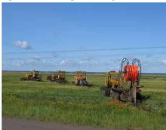
Рис.9.2. Прокладка труб (кабеля) непосредственно в грунт.
