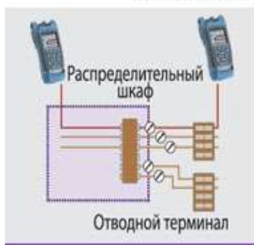
Рис. 4. Применение двух OLTS для проведения паспортизации кабельной сети
