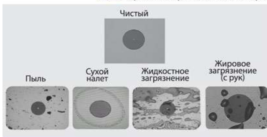
Рис. 2. Варианты загрязнения коннектора
