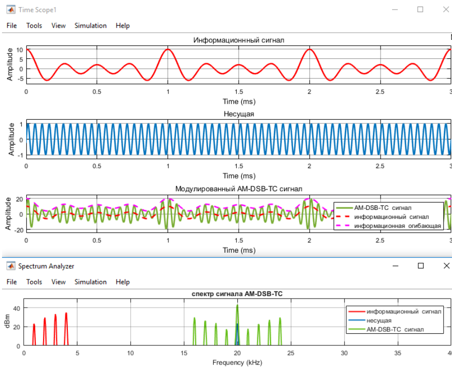
Рис. 5.8. AM-DSB-TC для четырехтонального информационного сигнала
