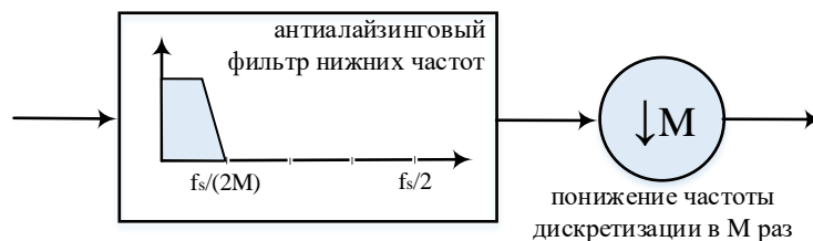
Рис. 7.63. Дециматор: антиалайзинговый фильтр и понижающий дискретизатор
