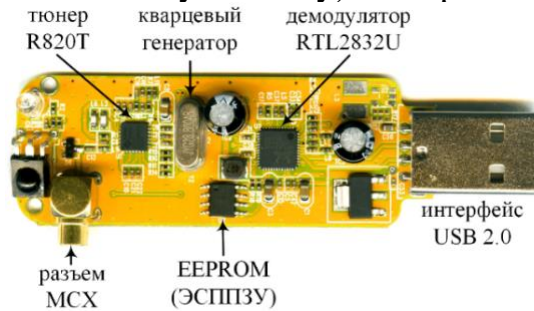
Рис. 1.9. Основные микросхемы приемника RTL-SDR (NooElec)
