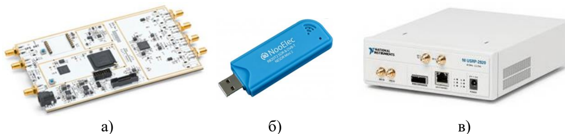
Рис. 1.6. Отладочные платы ПКР: а) Ettus B210; б) RTL-SDR; в) NI USRP-2932
