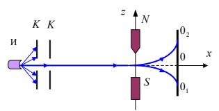
атомы, обладающие магнитным моментом, должны отклоняться от направления их первоначального распространения. На атом с магнитным моментом  $\vec{M}$  в неоднородном магнитном поле  $\left(\frac{\partial \vec{H}}{\partial z} \neq 0\right)$  действует сила,
