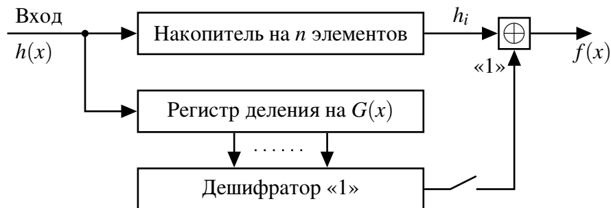
Рис. 2.7. Функциональная схема декодера с исправлением однократной ошибки при последовательном считывании
