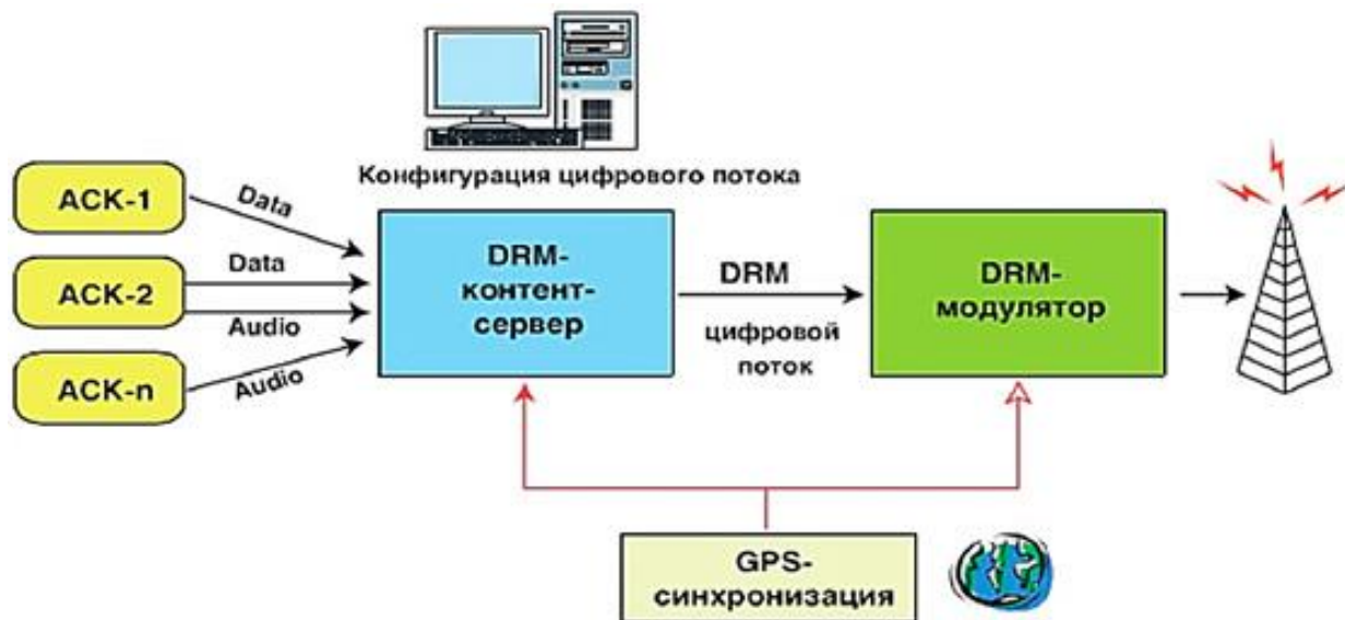
Рис.1. Укрупненная структурная схема системы цифрового радиовещания
