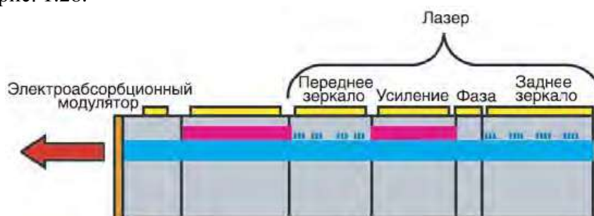
Рис. 1.28. Упрощенная конструкция и схема включения интегрированного моноблочного излучателя на основе ЛД SG DBR
