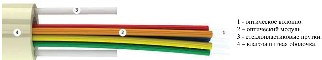
Рис. 6.14. ВОК с периферийными армирующими элементами.
